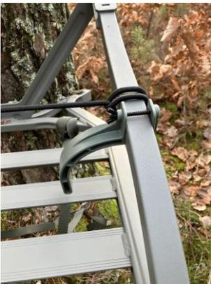
Abb. 11 Montage Fußsteigbügel 1
